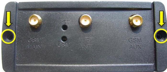
2. Entfernen Sie die Rückseiten-Abdeckung.
