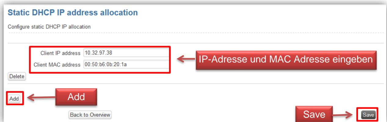
**Tipp:** Unter **Status** → **Routes** werden bei **ARP** die aktuellen MAC-Adressen der am MX510 angeschlossenen Endgeräte angezeigt. Diese können Sie dort mit der Maus markieren & kopieren und hier bei „*Client MAC address*“ einfügen (Strg V).
