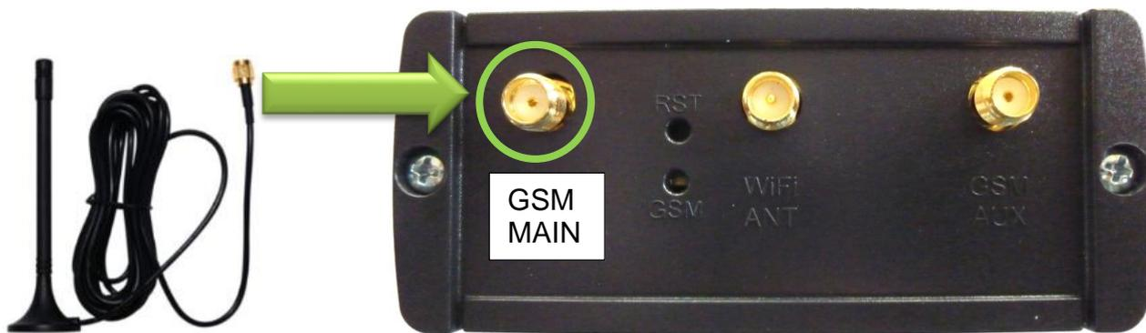
Die Magnetfußantenne ist nur erforderlich, wenn die Verbindung mit einer im MX510 eingesetzten SIM-Karte per Mobilfunk hergestellt wird.
